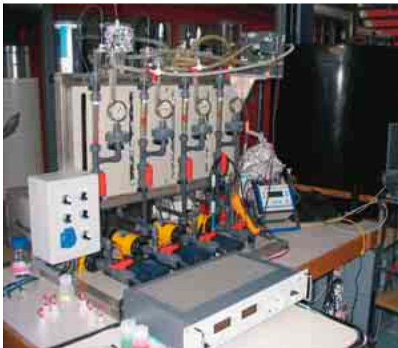
Elektrodialyse-Anlage, benutzt für die Laborversuche.
